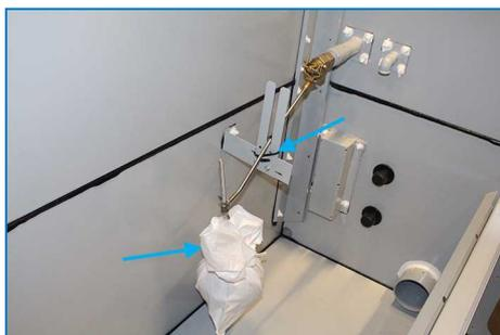
*Fissaggio e avvolgimento della palla galleggiante*
